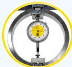
ساعت اندیکاتور نیرو (نمایش مقدار بار)
