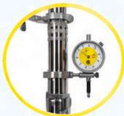
ساعت اندیکاتور تغییرات عمودی (نمایش تشست)
