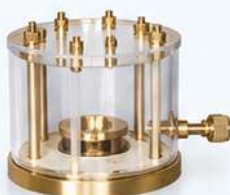
سل نمونه از جنس برنج CNC شده با محفظه پلکسی شفاف
